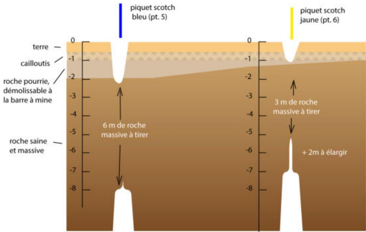
Les fractures remontantes ne sont pas dessinées dans le bon sens : en réalité elles sont orientées dans le sens de la coupe, à 64° (vu l'azimut entre les deux piquets, c'est peut-être la même fracture).
