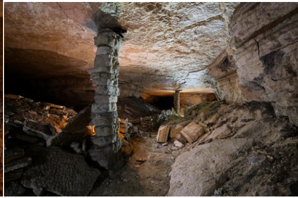
Gauche : Malgré son apparence saine, cet ancien roulage agrémenté de cales à bras est très dangereux d'accès. Droite : D'anciennes galeries de seconde masse soutiennent péniblement les lourds piliers de l'étage supérieur...
