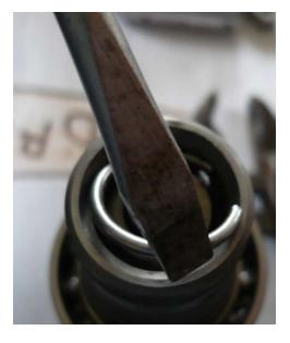
Avec un gros tournevis plat, pousser l'autre extrémité du circlip (attention aux yeux !)
