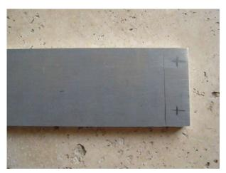
Le plus important est de bien pointer les deux trous pour respecter l'entraxe, et de les percer au bon diamètre le plus droit possible (perceuse à colonne souhaitable). Ensuite avec une bonne scie à métaux, une bonne lime et un touret, on taille le reste de la biellette autour des trous, de manière à ce que rien ne dépasse plus tard quand elle sera montée.
