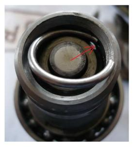
Caler une extrémitié du circlip contre le trou qui a servi à le soulever lors du démontage
