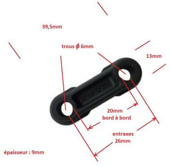
Nous allons donc tailler une biellette dans un morceau d'aluminium. Le plus facile, c'est de partir d'un plat de 8mm d'épaisseur (car 9mm pas courant), et de 40mm de large. Moyennant quelques coups de lime, on a déjà 2 côtes sur 3. On peut le commander sur <a href="www.blockenstock.fr">www.blockenstock.fr</a> où on trouve des chutes de tous les métaux à un prix de quelques euros (+ frais de port d'une dizaine d'euros).
