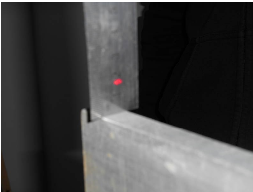
On mesure la distance entre la règle et le faisceau le plus loin possible du boîtier
