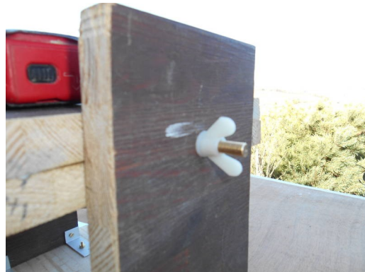
Papillon en plastique permettant de fixer le plateau tournant
