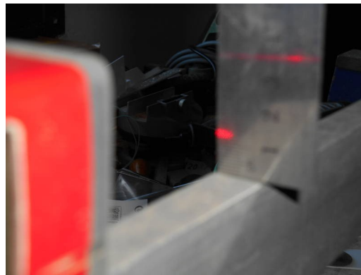
On mesure la distance entre la règle et le faisceau le plus près possible du boîtier
