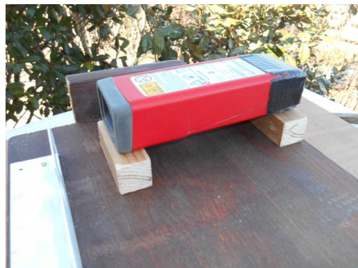
Cales de bois pour surélever le boîtier afin permettant l'accès au bouton de contrôle avec le doigt
