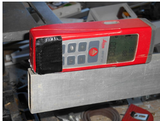
On colle des bandes d'adhésif jusqu'à ce que le faisceau soit aligné
