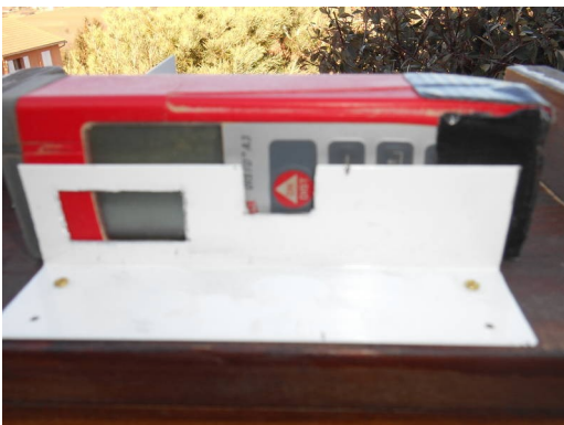
Fenêtre au centre permettant d'accéder au bouton de contrôle et fenêtre à gauche pour laisser passer le faisceau laser
