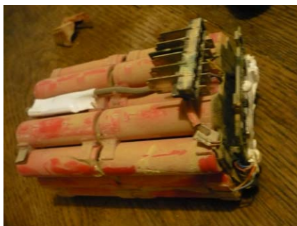
(accu Hilti 3,9Ah : 30 éléments couplés 3 par 3)
