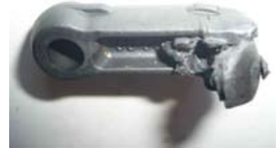
la bielle endommagée.
