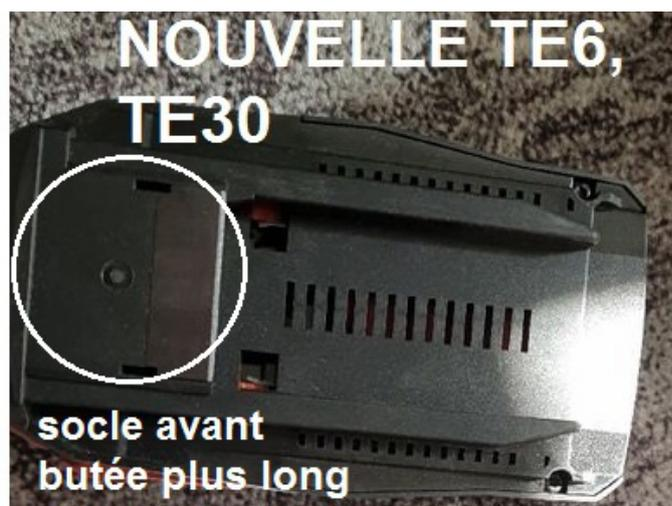
Ces nouveaux accus existent en 2,6Ah, 5,2Ah, et 9,0Ah. Sur l'accu, il est marqué « B36 \ 2.6 Li-Ion ». Les chargeurs diffèrent eux aussi.
