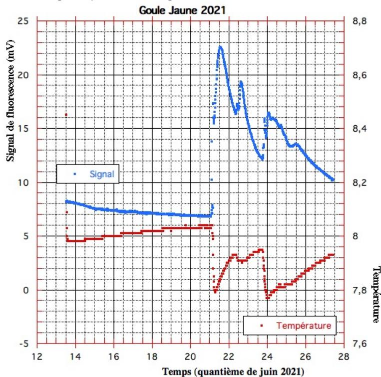
La baisse des températures correspond à l'arrivée de l'eau d'orage et elle est accompagnée d'une montée de la fluorescence (faible néanmoins). De même, l'eau d'orage est trouble comme le montre la courbe suivante.
