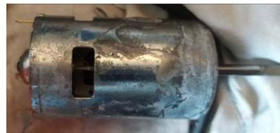
Malgré un siliconage en règle, un bourrage de graisse des joints de l'arbre, et la pose soigneusement verticale pour profiter de l'effet "cloche de plongeur", l'eau est quand même passée dans le moteur.
