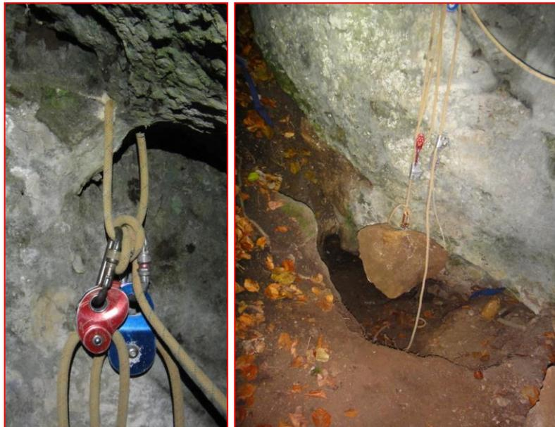
au plus loin dans la diaclase située à proximité. Bien vite, Vincent tombe sur un bloc trop gros pour rentrer dans le bidon, ni même être roulé vers la sortie. J'installe un palan en m'accrochant sur un petit amarrage foré, en espérant qu'il soit suffisamment résistant. Le bestiau est attrapé « par les cheveux » à l'aide d'une cheville à visser. Le bloc est rapidement extrait et stocké sur le bord du chantier. A cette heure tardive
