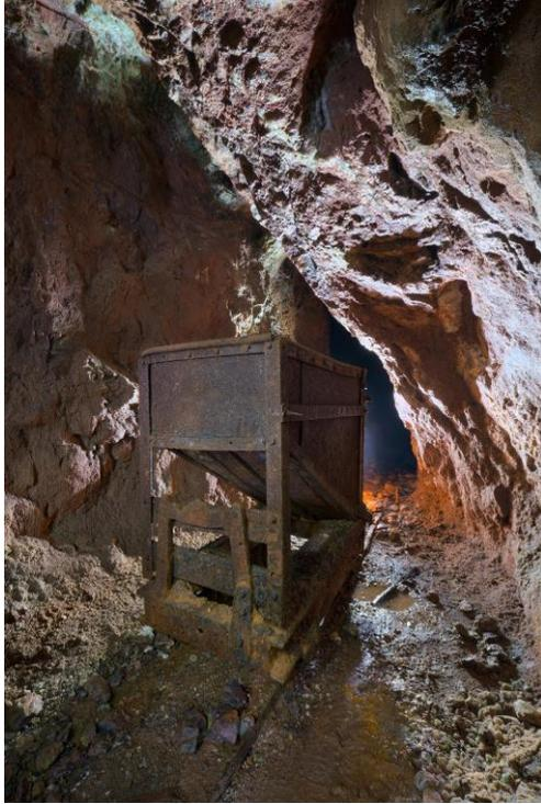
Au niveau 0, le roulage en voie de 60 est encore en place. L'aspect de la roche est assez diversifié, on a parfois des roches translucides vertes dans le filon de fluorine, des venues de barytes, ou de la paroi volcanique.
